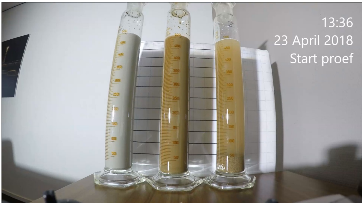
Figuur 2: De transparantie 8 minuten na het homogeniseren van de kolommen met zand als laatste: De strepen achter de kolommen zijn niet door de kolommen te zien.
